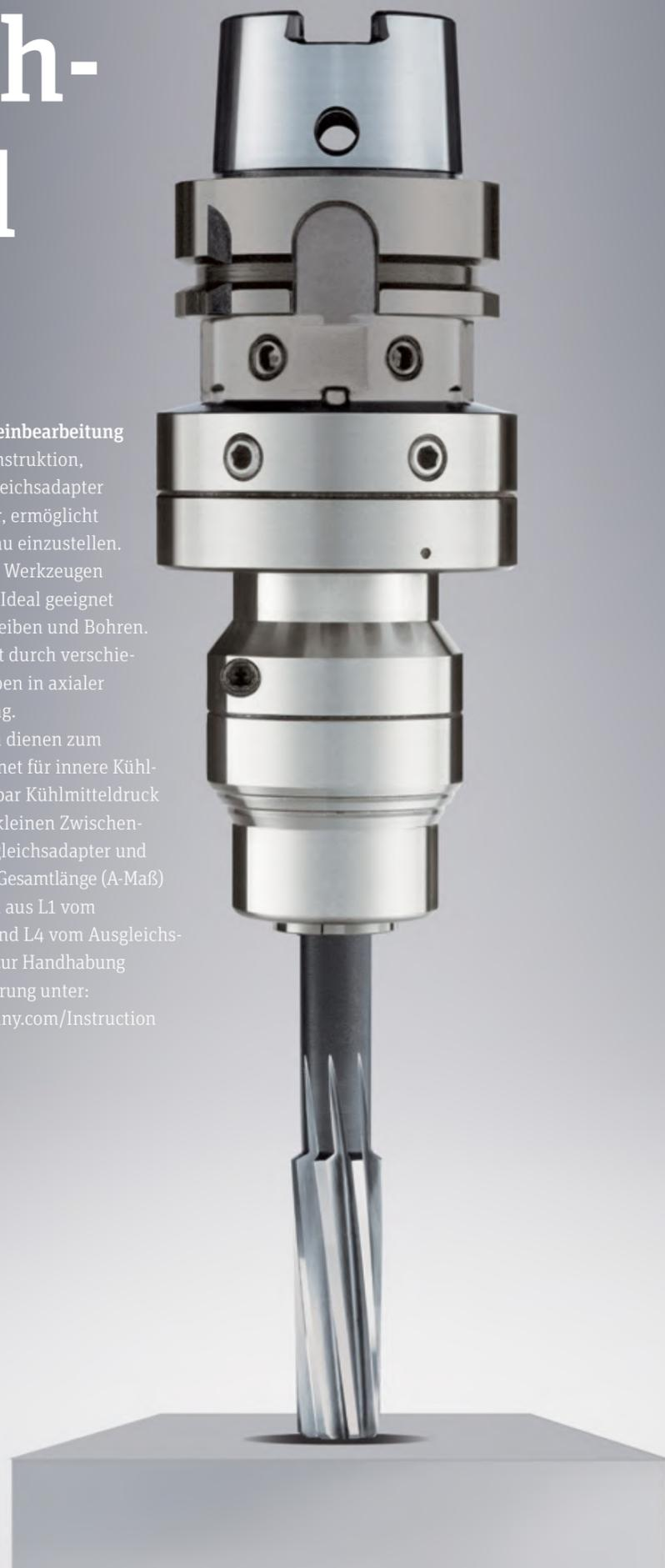
**Ausgleichs-Spannfutter APC.** Höchste Spannkraft durch integriertes Schneckengetriebe. Schneller Werkzeugwechsel erfolgt seitlich durch Sechskantschlüssel. Wartungsfrei. Abgedichtet gegen Kühlmittel und Verschmutzung. Flacher Kegelwinkel. Spannen von Zylinderschäften nach DIN1835 A, B und DIN 6535 HB, HA sowie HE bis D = 20 mm.
